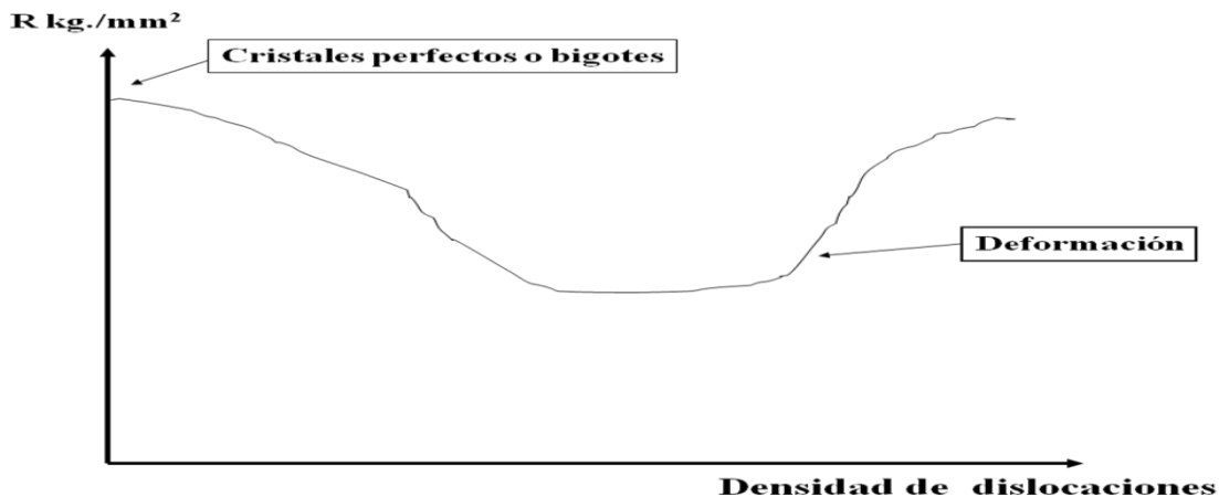
Figura. 1 Influencia de la densidad de dislocaciones en la resistencia de los materiales metálicos.
